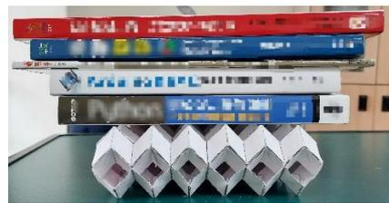
圖(五) 三浦方塊上下可荷重
