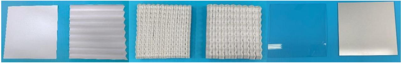
圖(六) 依序為未摺疊紙張、W 摺疊紙張、1.5 方塊、2.0 方塊、PC 板和塑鋁板
