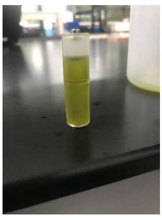
圖二 有葉綠素溶液的電池模具(模具 5mL)
