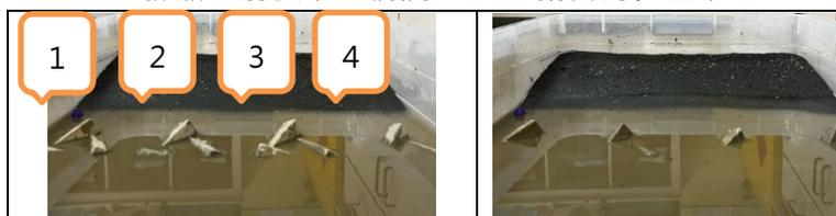
圖九 三和塊前後下陷情況，1~4 號皆有明顯下陷，幾乎全被淹沒在水中。
