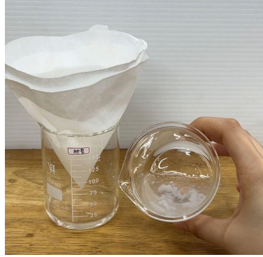
圖(七)肥皂加入鈣離子後的白色沈澱
