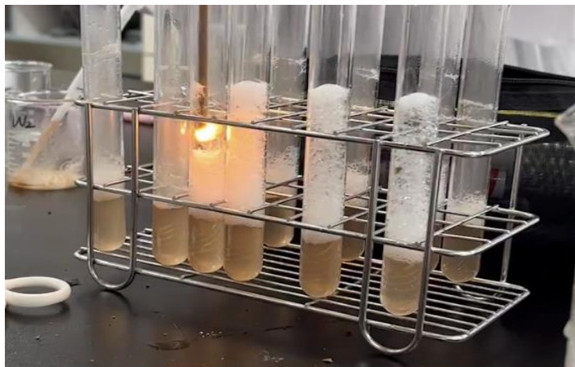
圖四：點燃後線香放入試管中觀察試管中氣體之助燃效果 (資料來源：研究者自行繪製)
