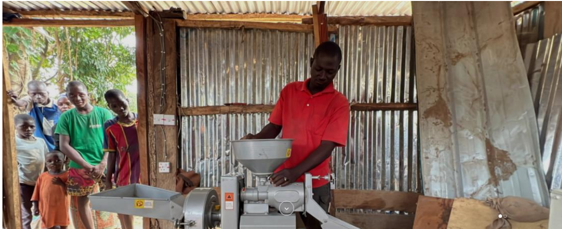
圖 2 米糠處理機械使用示範
