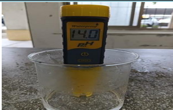
圖(4)調製 pH 濃度。用 氫氧化鈉和鹽酸 水溶液調各個 pH 值。
