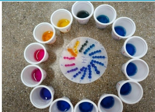
圖(3)蝶豆花晶球酸鹼指示劑，不同 pH 的色票，用手機下載軟體測量其 RGB 值。
