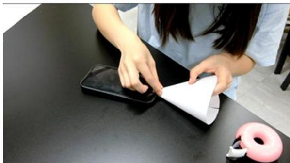
（3）將分貝測量器 B 放在距出音孔 A 45 公分處（4）A 播放特定音頻，並記錄 B 測得音量
