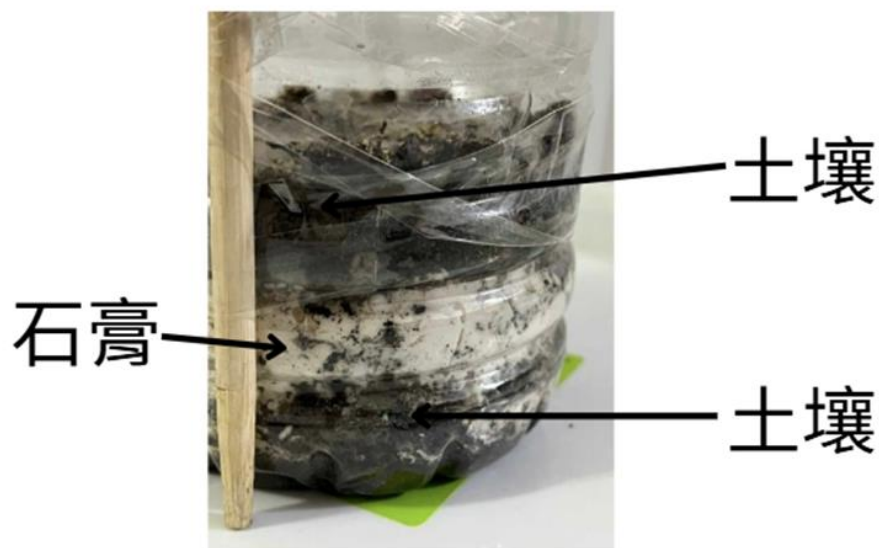
圖二 溶洞(石膏)實驗設備
