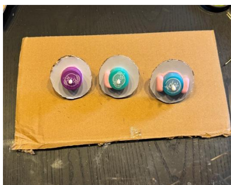
圖一 製作三種不同配重之陀螺。
