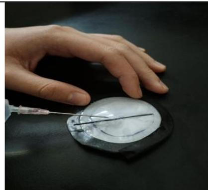
絕緣膠帶封口及注射溶液
