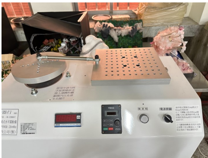
圖 1 變頻式水平地震儀
