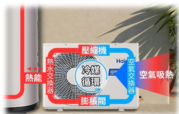
圖二：分離式熱泵熱水器運作原理示意圖。
