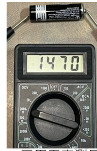
▲三用電表測量電池端電壓
