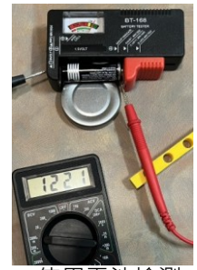
▲使用電池檢測器同時量端電壓，發現電壓更低
