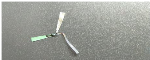
圖 1-11 A 牌巧克力鋁箔和紙受熱易分離
