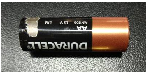
圖 2-3 刮除鹼性電池外漆
