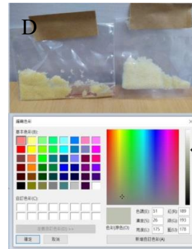
圖二：透氧性測試圖。A 為抗壞血酸滴定使用碘酒體積、BD 為抗壞血酸變色色階圖、C 為實驗過程圖。
