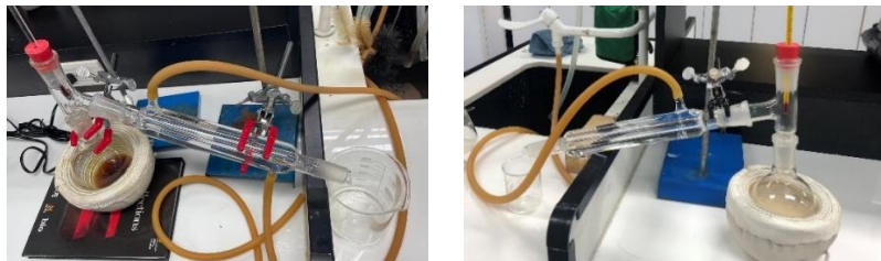
圖一 簡單蒸餾裝置
