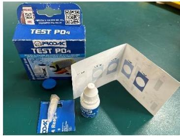
圖 8 以磷酸試劑進行濃度測定
