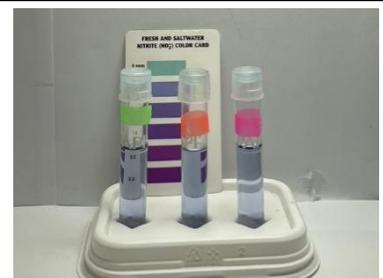
圖 6 以亞硝酸試劑進行濃度測定
