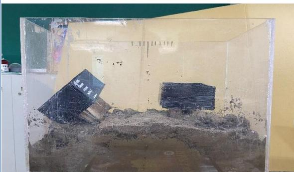
左圖的實驗要比較正方形柱狀地基和長小向外地基的穩定度，向外地基（左邊）脫離土層，靠牆傾倒，正方形柱狀地基上方小部分脫離，所以正方形柱狀地基（右邊）比長小向外地基穩固。
