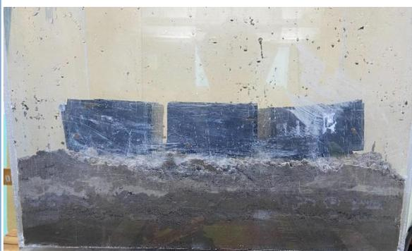
左圖實驗要比較正方形柱狀地基、六邊形柱狀地基，和大六邊形柱狀地基的穩定度，六邊形柱狀地基鬆脫最嚴重，在來是正方形柱狀地基，大六邊形柱狀地基則幾乎沒有鬆脫，所以大六邊形柱狀地基是最穩固的。
