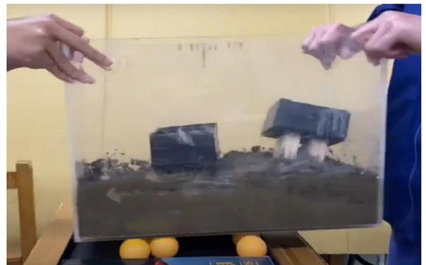
我們在壓克力箱裡面加水、土，接著把地基模型安插在土上。壓克力箱下方放置乒乓球，使裝置能順利搖晃。
