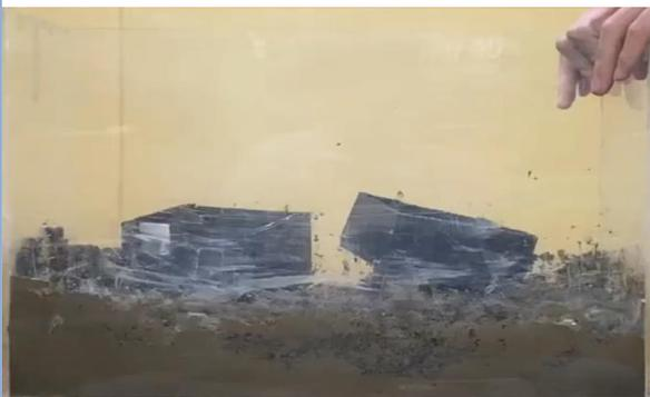
左圖實驗室要比較地基長度對穩定度的影響，小向外地基（右邊）整個傾斜，只剩一小部分的地基在支撐，長小向外地基，只有些微轉向，所以長小向外地基比小向外地基穩固。
