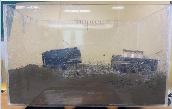
左圖的實驗是要比較地基方向向內和向外對穩定度的影響，左圖中向外地基崩塌，甚至整個顛倒。向外地基只有右邊隆起，所以向外地基比向內地基穩固。
