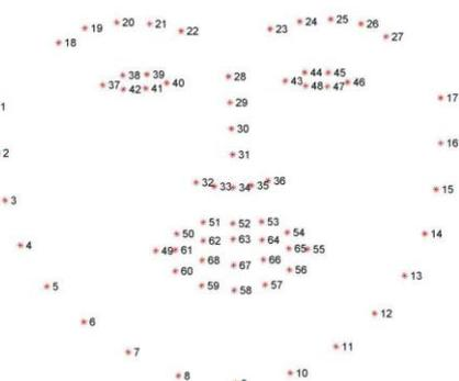
圖 4：在安裝資料夾中找到目標檔案-Dlib 人臉的 68 的特徵點
