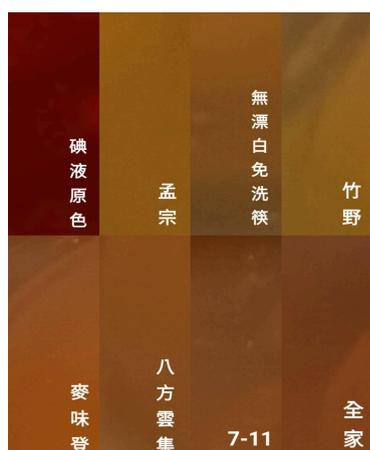
【圖一】七個牌子泡在稀釋碘液三小時後的褪色情形
