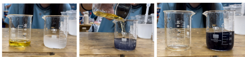
【圖一】乙醯胺酚與硝酸鐵的變色反應
