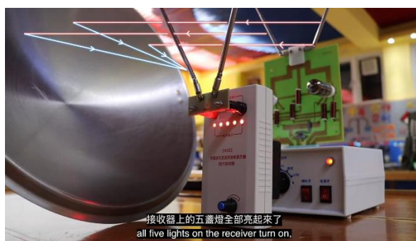
圖 3.2：接收器上的五盞燈亮了，即說明了無線電波經過反射後，成功被接收器接收並探測到
