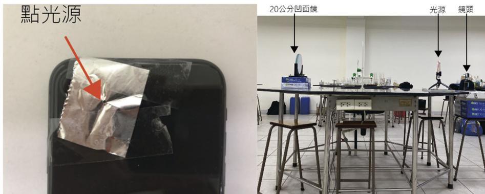
圖三：製作點光源、圖四：實驗架設圖
