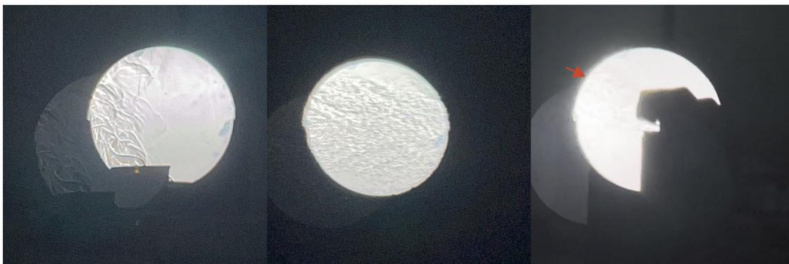
圖九：蠟燭成像、圖十：吹風機成像、圖十一：汽水成像
