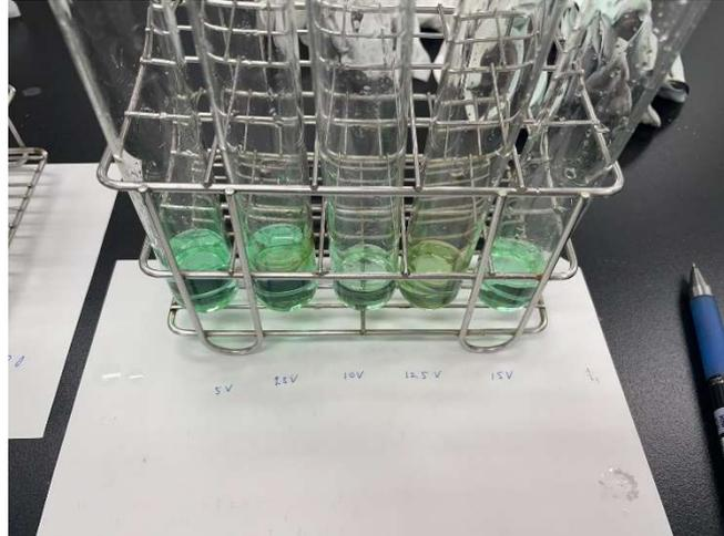
圖(一)硫酸鎳溶液滴入同體積、電解時間不同之電解液後之澄清液
