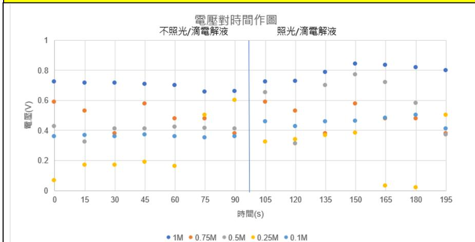
與預測相符地，以 1M  $KI_3$  作為電解液使電池具有最大電壓。
