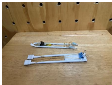
圖 11：掌上型發射架成品，用以固定發射力道及角度。
