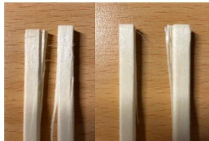
圖十一：將筷子擺橫，上下方向施力測試結果
