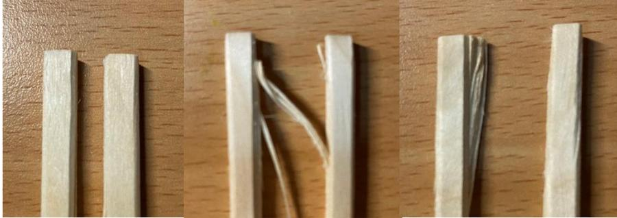
圖九：以美工刀加深刻痕測試結果 1、2、3
