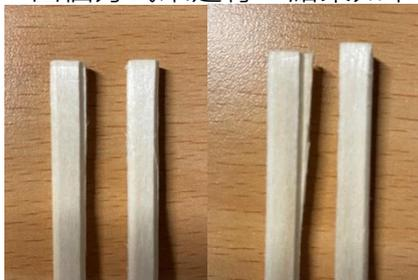
圖十：將筷子擺直，左右方向施力測試結果
