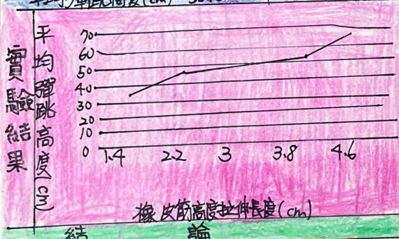
橡皮筋拉伸長度越長，彈跳高度越高。
