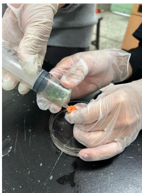
圖(二) 將葉片放進針筒後抽取雙氧水，並將塞子塞住針筒口
