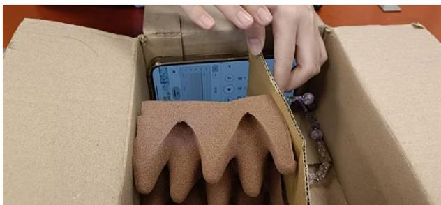
圖(十) 吸音棉隔音裝置
