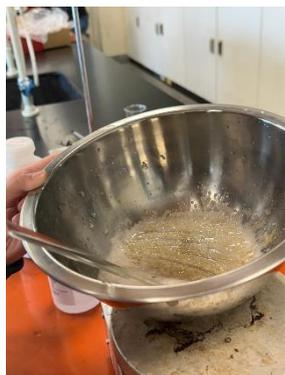
圖(四)明膠與甘油混和膠的製作
