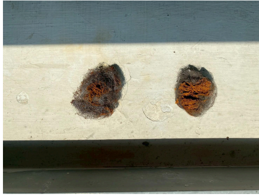
圖一、噴灑鹽水(左)與浸泡鹽水(右)正面生鏽狀況比較
