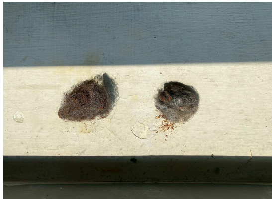
圖一、噴灑鹽水(左)與浸泡鹽水(右)正面生鏽狀況比較
