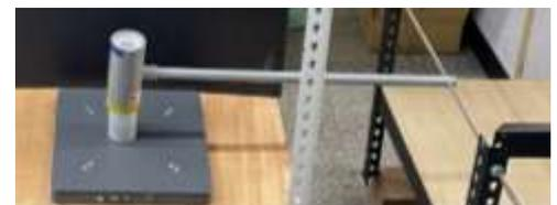
圖 17 自製大槌敲擊裝置
