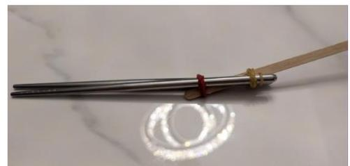
的力道相仿。讓紙種子能從最高處開始旋轉是因為若不先提供動力，紙種子會從半空中才開始旋轉，而導致每次開始旋轉的地方都不相同。這可能使每次的實驗結果有許多誤差，因此在最高處提供動力能解決這一問題，而橡皮筋發射器則是讓紙種子每次所受的力道相同。
