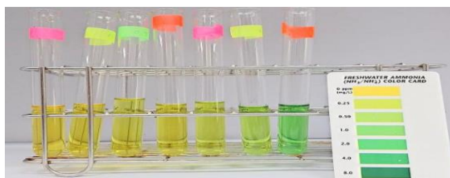
圖 2-2 可透過 App 偵測顏色 HSL 計算判斷濃度
