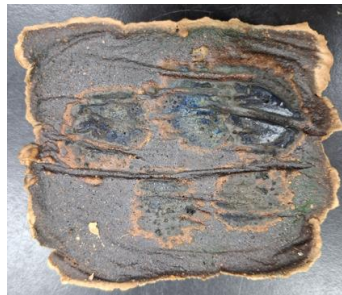
圖六、環保材料燃燒後之正面(左)和反面圖(右)
