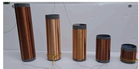
▲【圖8】所有尺寸的特斯拉線圈
