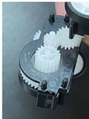
圖(四): 迴力車1 內部結構
