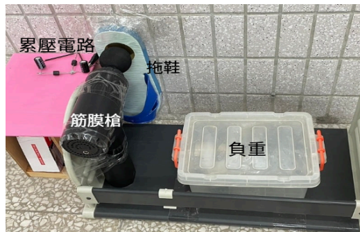
圖四 固定式敲擊裝置架設圖
