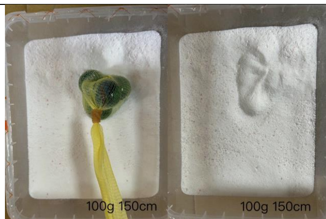
(圖五) 100g 從 150cm 處落下
