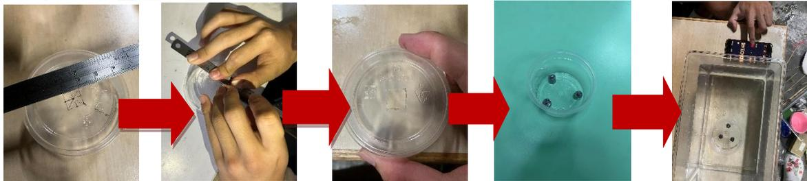
**注意:** 破洞的塑膠碗保持浮在水面上的原因是它本身的密度較低，浮力足以抵消它的重力。但是，當你往碗內加入額外的重量時，碗的總重量增加，浮力無法再支撐它，就會導致碗下沉。因此實驗我們以三顆五公克的砝碼作為重物
