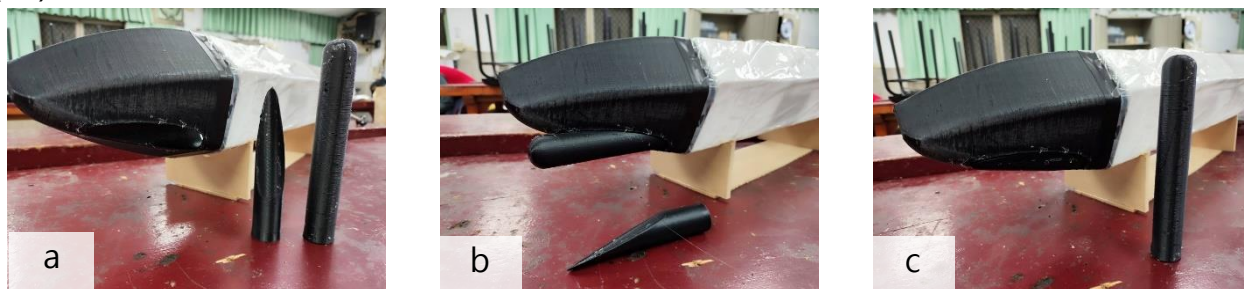
圖四 a 為 3D 列印成品；b 為球鼻艏組裝(且可調球鼻艏長度)；c 為無球鼻艏的配置
