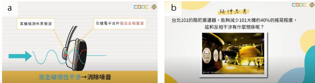
圖十 反向波於生活中的應用 a 為主動式降噪耳機；b 為台北 101 大樓阻尼器抗震
