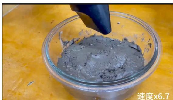
圖一用吹風機吹到產生泥裂
