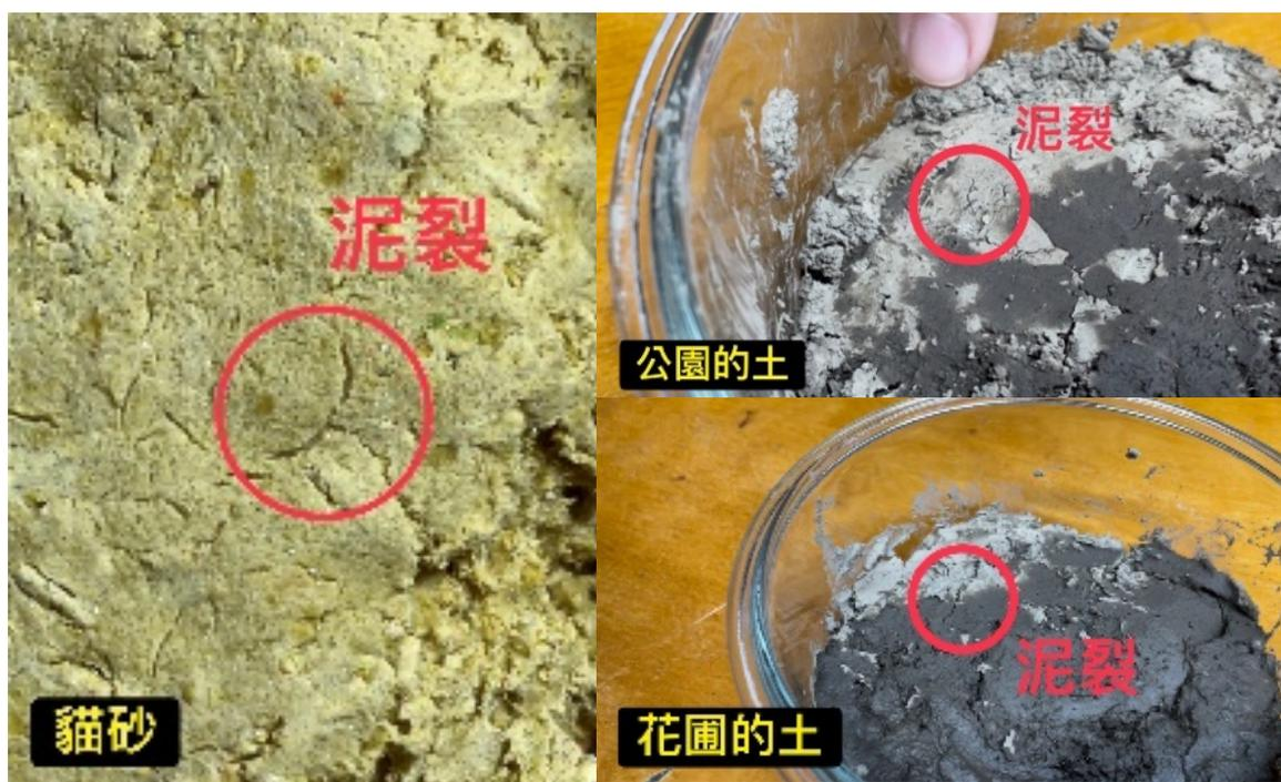
圖二 三種不同材質泥裂結果
