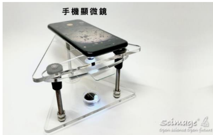
圖（一）簡易手機顯微鏡
