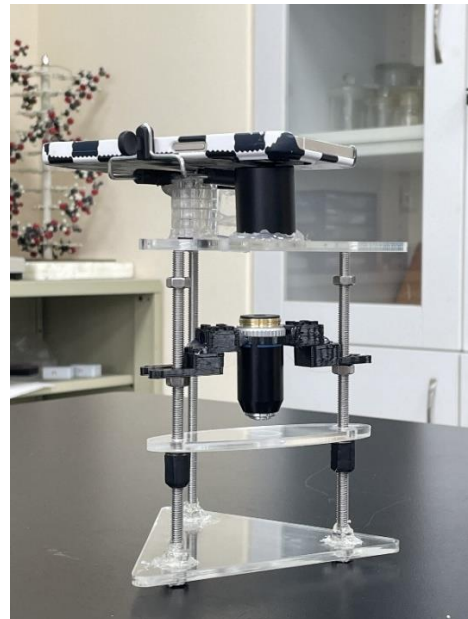
圖（三）實際的手機顯微鏡裝置
