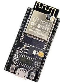
圖 1：NodeMCU-32s 開發版
