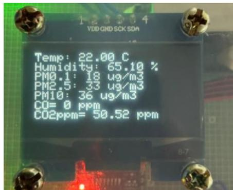
圖 13:OLED 顯示樣貌
